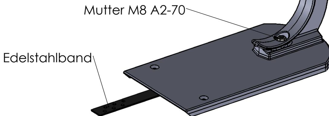
Werkstoff: Gussteil: EN AC-AISi12(Cu)
