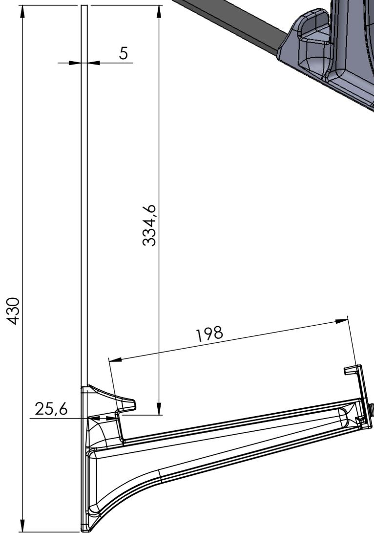
Werkstoff: Gussteil: EN AC-ALSi12(Cu)
